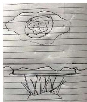
La genèse de la fabrication d'un mobilier : un croquis réalisé à main levé par Marc et la mise en page et le dessin assisté par ordinateur par Jessy, qui propose plusieurs modèles avec échanges d'idées. Marc va ensuite choisir la pierre dont il va préserver toute l'authenticité et les formes initiales. Les chants seront bruts tandis que le plat est poli manuellement.
